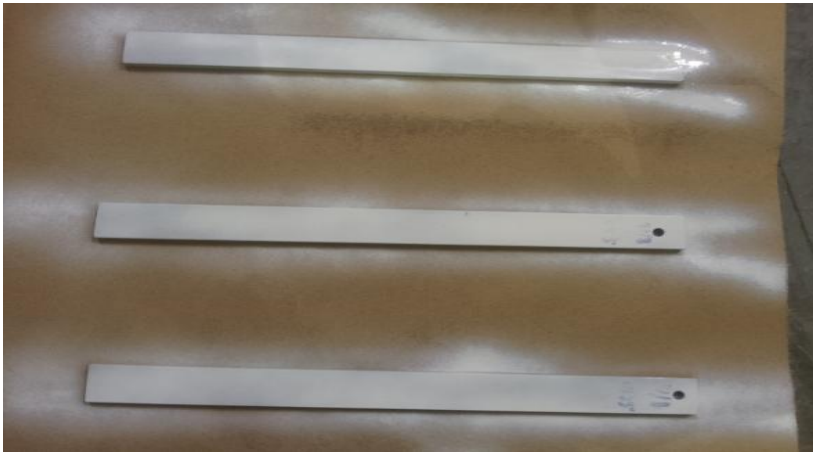
Al 분말 Undercoating : SC-UC는 비가연성의 반사성질의 undercoating
